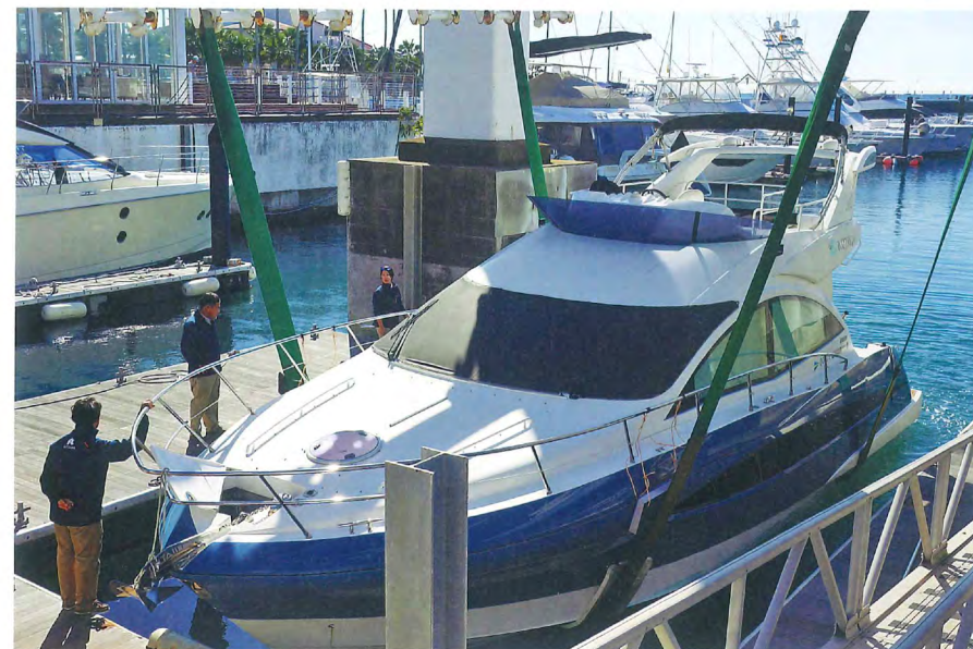
クレーンでの上下架作業はマリーナスタッフの重要な業務。真夏は終日この作業が続き、スタッフは体力勝負となる。この日はクレーン操作をする堀越さんを含め3人のスタッフが協力して作業を行っていた
