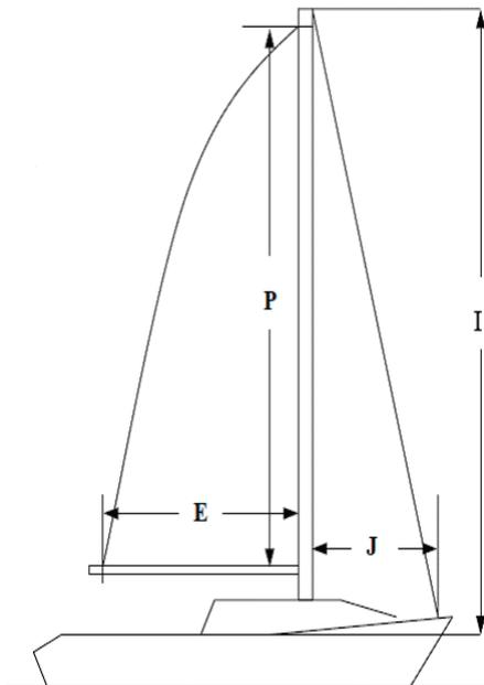
**I** = 「マストとジブステイの交差点」か「マストとジブハリヤード用滑車の最上部」のいずれか高い方と「シアーラインからマスト垂直に引いた線とマストの交差点」の間の距離
