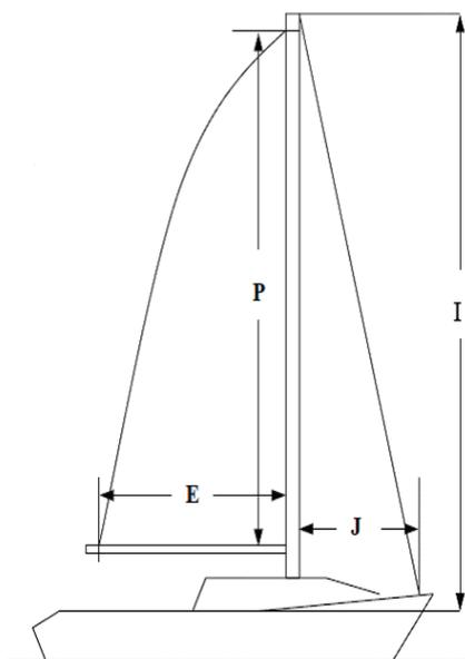
**I** = 「マストとジブステイの交差点」か「マストとジブハリヤード用滑車の最上部」のいずれか高い方と「シアラインからマスト垂直に引いた線とマストの交差点」の間の距離
